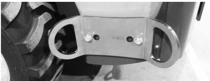
Soporte de amarre A418623 instalado en el lateral del chasis posterior. Para la instalación lateral, se necesitan dos soportes.
