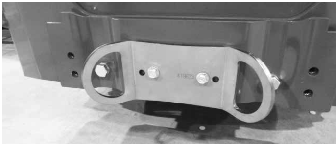
Soporte de amarre A418623 instalado en el parachoques o contrapeso traseros
